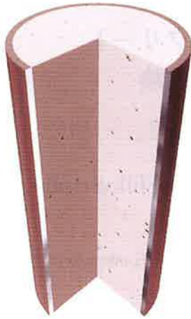
図-1 コンクリート充填構造 Concrete filled tube (CFT)
