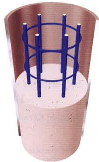
図-2 鉄筋コンクリート充填構造 Reinforced concrete filled tube (RCFT)
