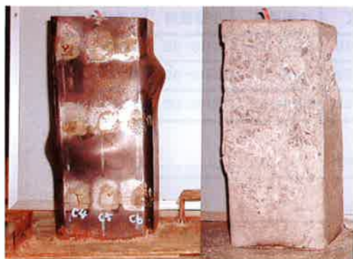
写真-2 圧縮せん断試験破壊状況：(60 LM-SC)
