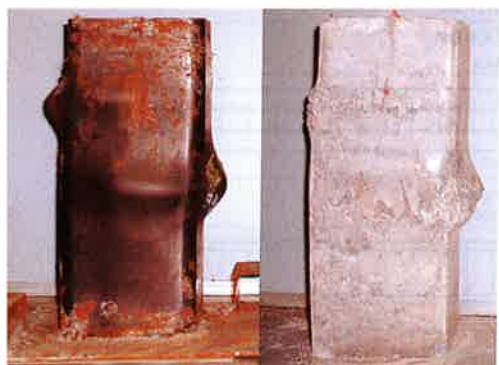
写真-3 圧縮せん断試験破壊状況：(60 HM-SC)
