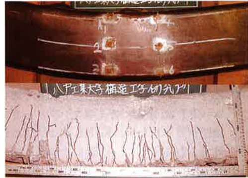
写真-10 曲げ試験破壊状況：(60-HB-SB)
