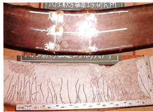
写真-11 曲げ試験破壊状況：(60-HS-SB)
