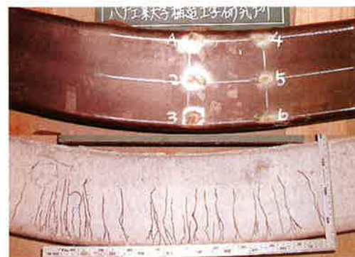
写真-12 曲げ試験破壊状況：(60-HW-SB)
