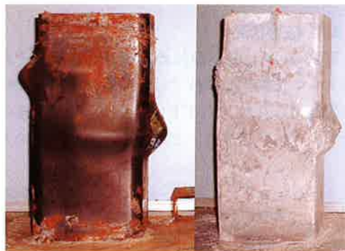
写真-4 圧縮せん断試験破壊状況：(60 HB-SC)
