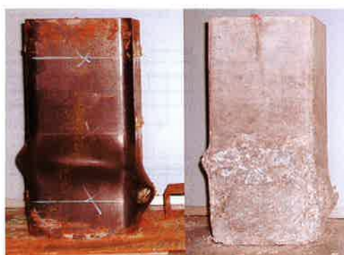
写真-6 圧縮せん断試験破壊状況：(60 HW-SC)
