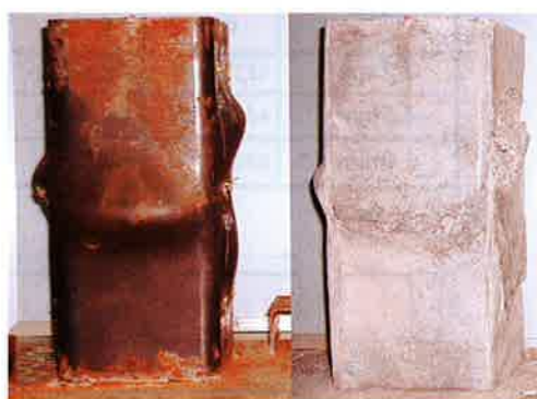
写真-5 圧縮せん断試験破壊状況：(60 HS-SC)
