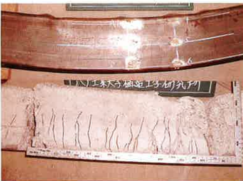
写真-8 曲げ試験破壊状況：(60 LM-SB)
