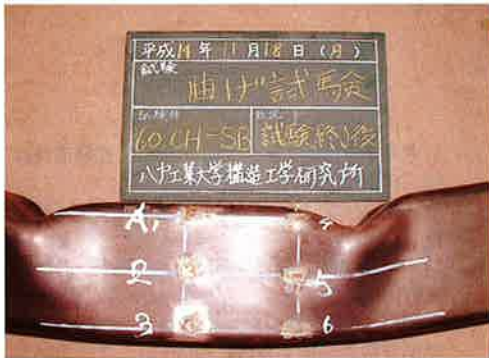
写真-7 曲げ試験破壊状況：鋼管のみ試験体 (60 CH-SB)
