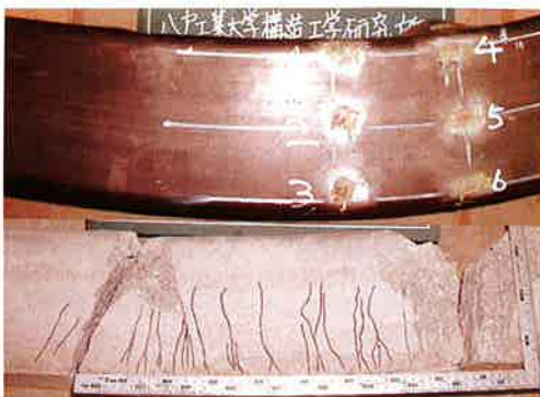
写真-9 曲げ試験破壊状況：(60-HM-SB)
