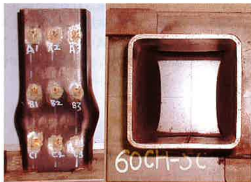
写真-1 圧縮せん断試験破壊状況：鋼管のみ試験体 (60CH-SC)
