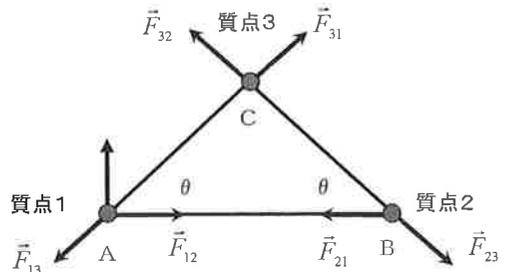
図6 撃力の力学的構造
