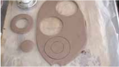
写真2 ドーナツ型試験片の作製
