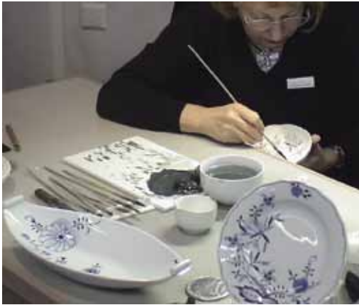
写真1 マイセン磁器の下絵付け作業 軸掛け後に1400℃以上で焼かれる。手前の2作品は完成品。
