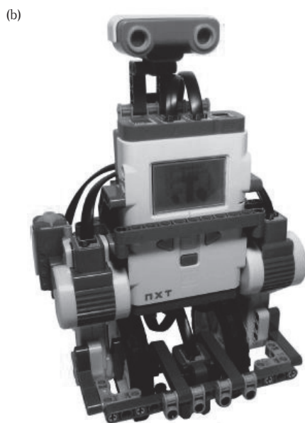
図 2 ET ロボコンの規定ハードウェア（車体） (a)RCX、(b)NXT
