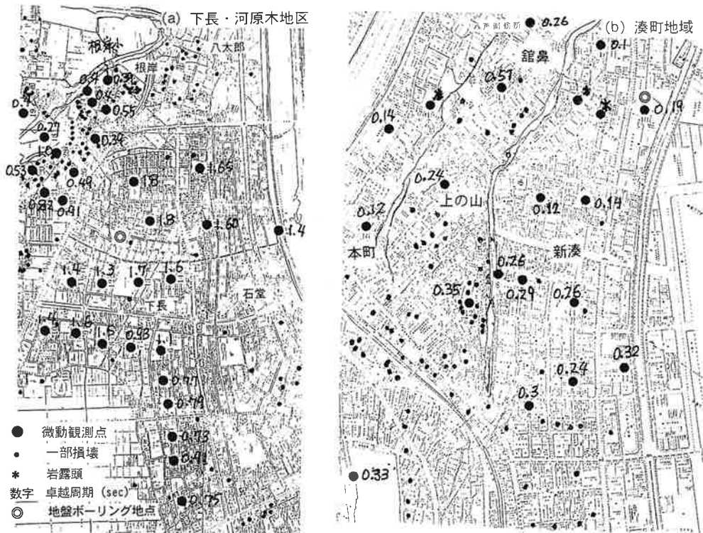
図4 一部損壊被害建物分布と地盤の卓越周期分布 (a) 下長・河原木地区 (b) 湊町地域(新湊・館鼻・上の山・本町)
