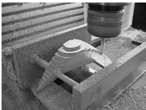
図 12 樹脂素材によるブレード製作段階
