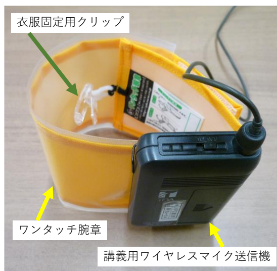
図 12 ワンタッチ腕章への講義用ワイヤレスマイク送信機の取り付け
