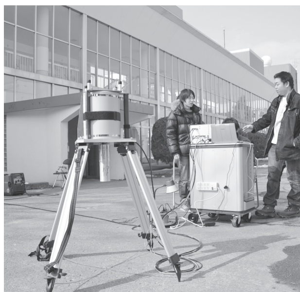
図7 放射線フィールドワーク ゲルマニウム半導体検出器を用いたIn-Situ測定実習
