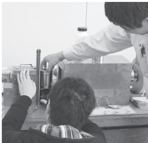
図5 放射線を利用したレベル計の基礎実験 (八戸工業大学)
