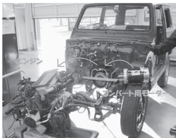
Fig.3 不要部品を取り外した車体
