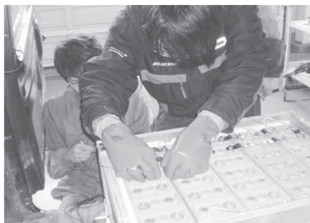
Fig.7 バッテリー接続の様子
