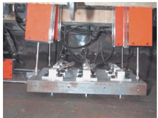
写真-5 群杭模型載荷試験状況
