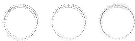
図-14 空洞周囲の主応力分布(円断面, \beta=0 , 左から n=0.25, 1, 4 )
