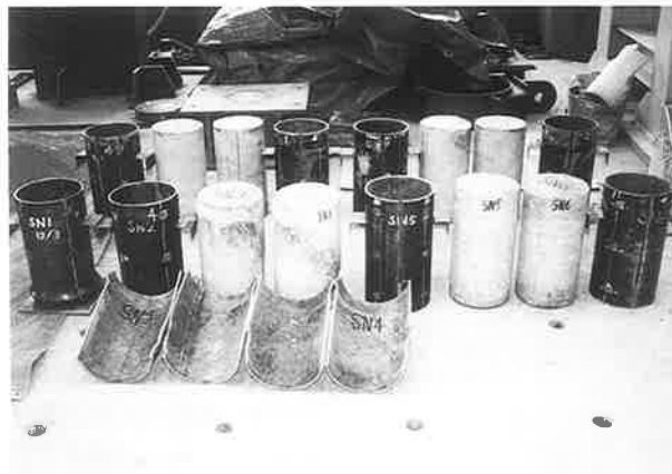
写真-3a SN グループ試験体の試験後状況
