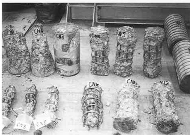
写真-4 CN グループ試験体の破壊状況
