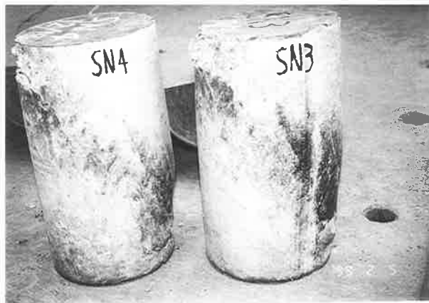
写真-3b 充填コンクリートの破壊状況
