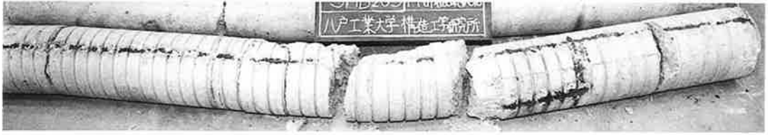
写真-3 SHB203 (リブ付き鋼管 CFT) の充填コンクリート破壊状況
