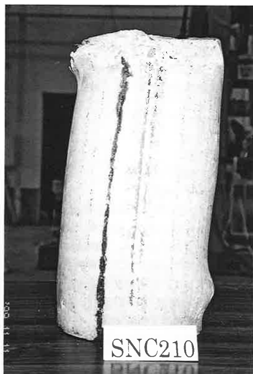
写真-1 SNC210 (普通鋼管二重配筋 RCFT) の充填コンクリート破壊状況
