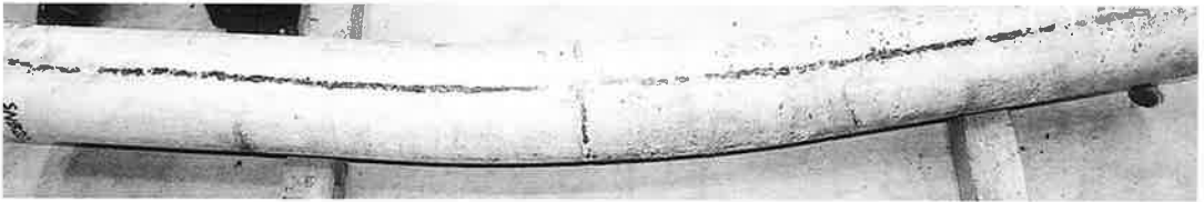
写真-4 SNB (普通鋼管二重配筋 RCFT) の充填コンクリート破壊状況
