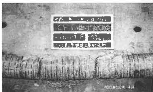
図-26 R60HM-Bの充填コンクリートの破壊
