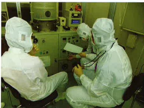
図 5.9: 真空蒸着装置による成膜工程
