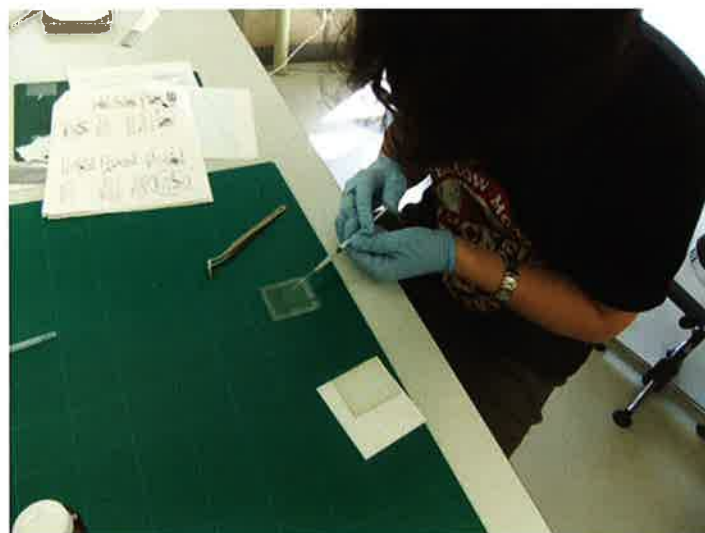
図 5.6: 液晶素子作製の様子（液晶注入行程）
