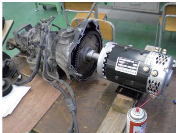
エンジンの代わりにモータを取り付け
