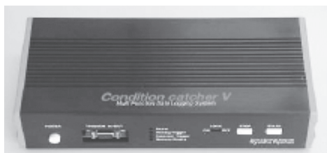
図 3 WEB で高速時系列電圧が取得可能な Condition Catcher V
