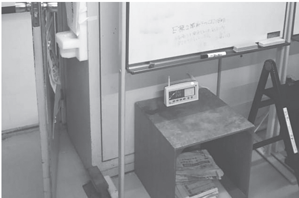
写真3 照明の消費電力の測定の様子
