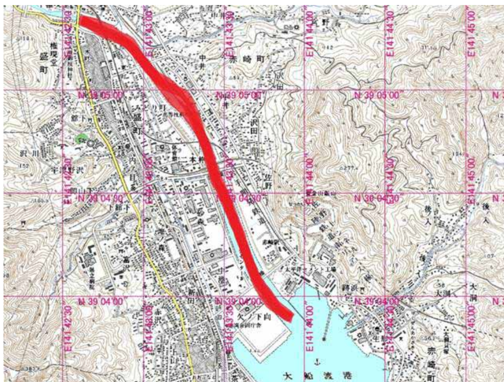
図3.4.1.1 調査地点 大船渡市盛川。赤色太線：津波遡上範囲、遡上点は現地漂流物を確認し、GPSを用いて測定。
