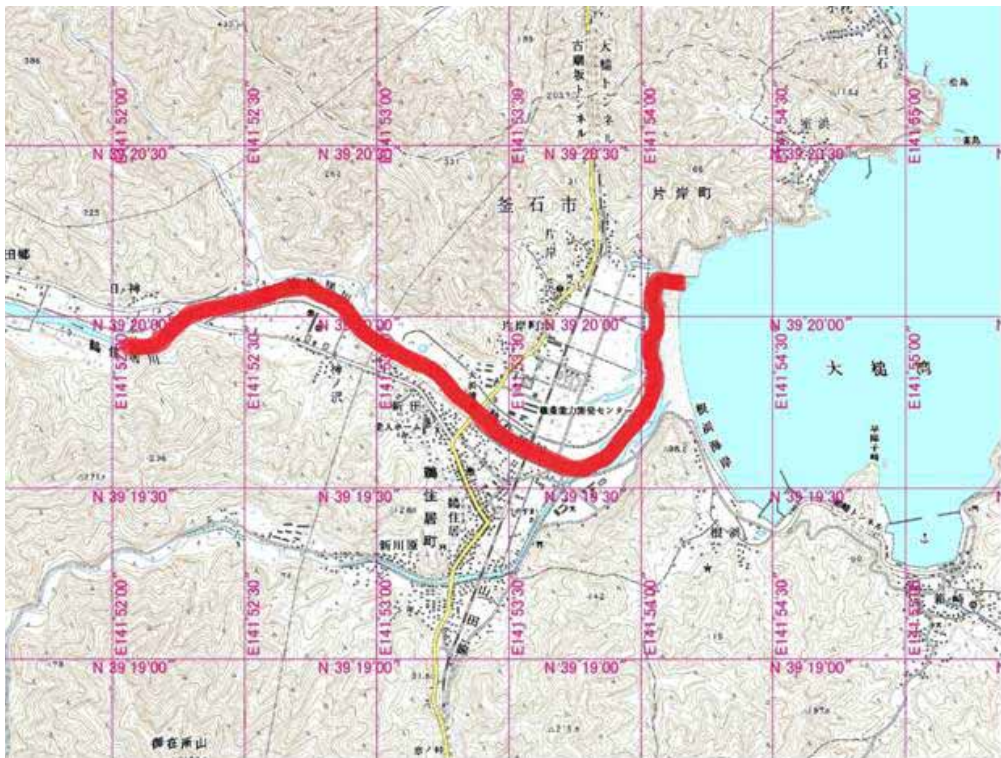
図3.4.5.1 釜石市鵜住居川の調査地点 赤色太線：津波遡上範囲、遡上点は現地にてGPSを用いて測定。大槌湾奥に鵜住居川の河口があり、湾に進入した津波は兩岸の街を襲っている。
