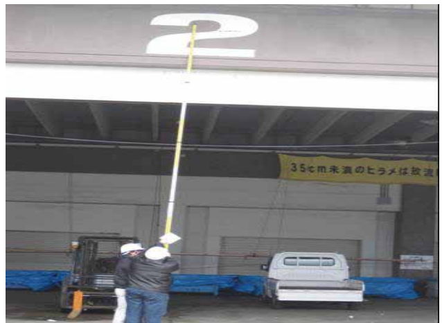
写真 3.3.18 三沢漁港北漁港魚市場の津波波高の測定状況。津波は 7.44m (TP)。
