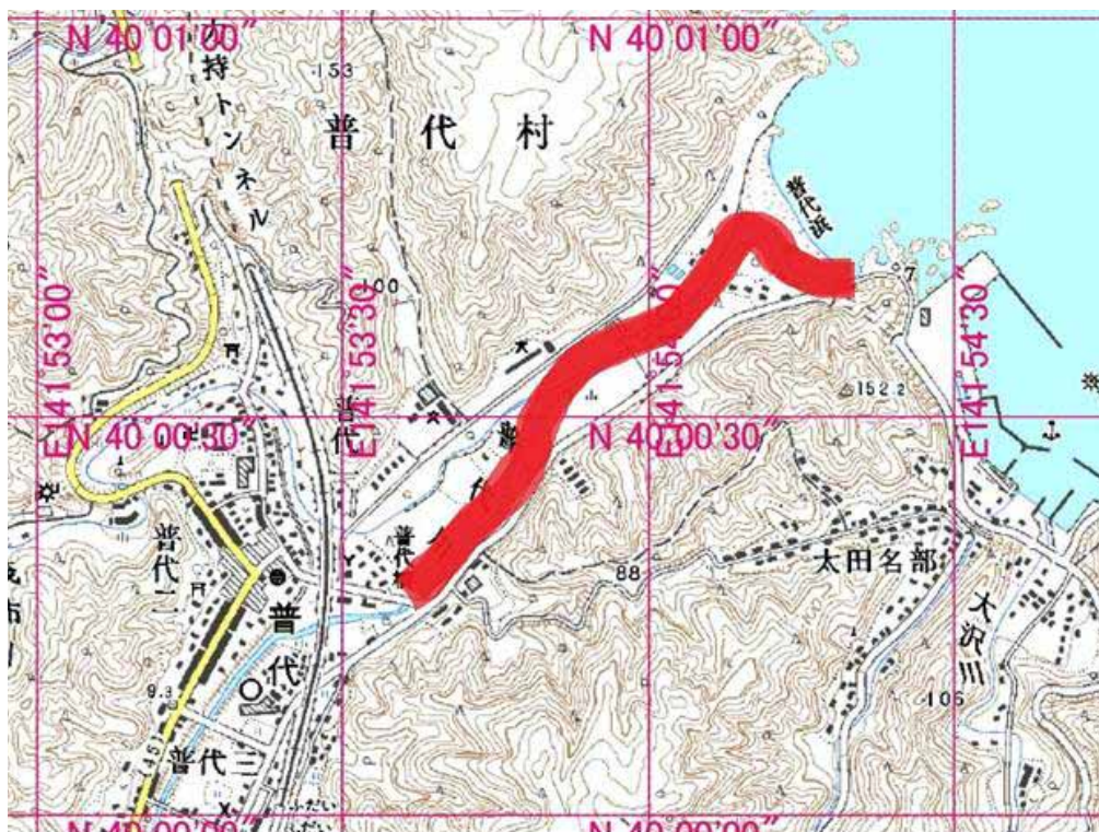
図3.4.15.1 普代村普代川の調査地点。赤色太線：津波遡上範囲、遡上点は現地漂流物を確認し、GPSを用いて測定。
