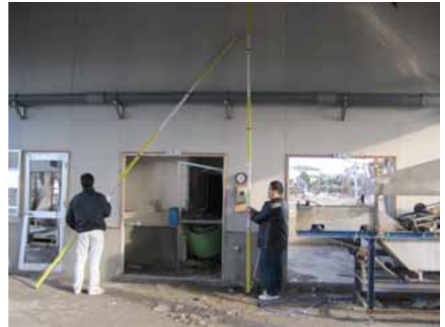
写真 3.3.1.8 階上町大蛇漁港上海産物簡易加工処理センター。壁に残った津波痕を測定する。津波 9.71m (TP)
