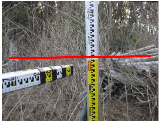
写真 3.3.2.9 奥入瀬川右岸市川水産加工団地北側津波遡上水深 0.99m（＝堤防越流水深）。赤線；津波水面
