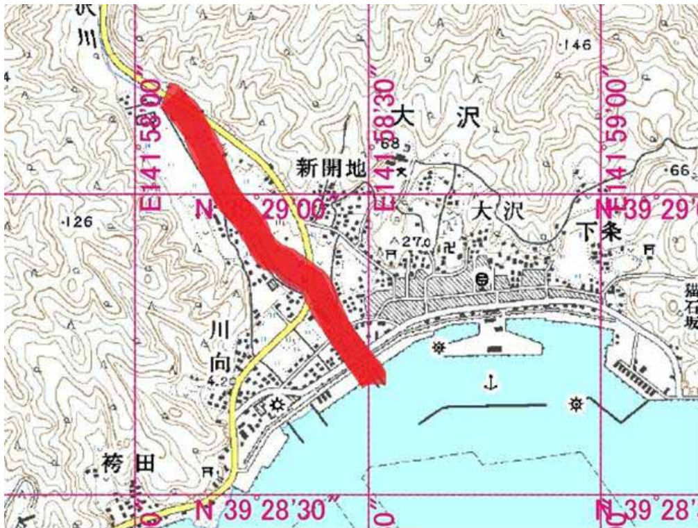
図3.4.8.1 山田町大沢川の調査地点。赤色太線：津波遡上範囲、遡上点は現地漂流物を確認し、GPSを用いて測定。
