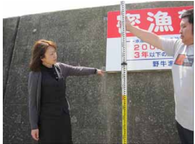
写真 3.3.4.5 野牛漁港、津波痕跡高。津波；2.35m（TP）。
