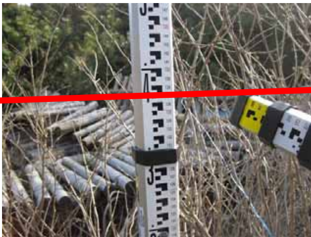
写真 3.3.2.10 奥入瀬川右岸市川水産加工団地中間 津波遡上水深 1.36m（＝堤防越流水深）。赤線；津波水面
