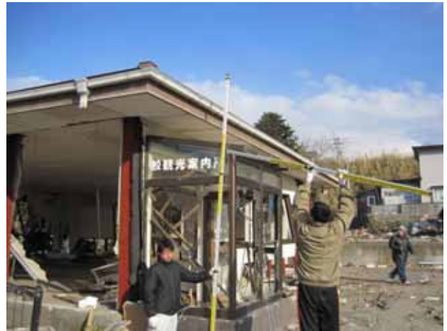
写真 3.3.2.5 蕪島の鮫観光案内所の被災状況。津波痕跡線高は 4.68m (TP)。
