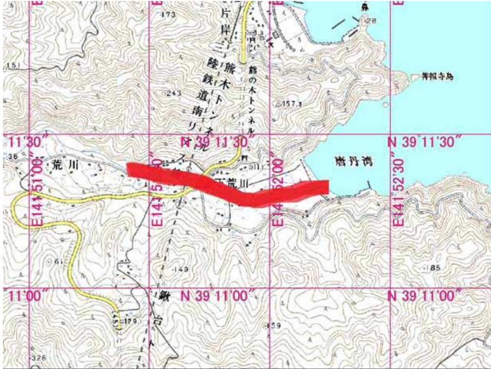
図3.4.2.1 釜石市熊野川の調査地点。赤色太線：津波遡上範囲、遡上点は現地漂流物を確認し、GPSを用いて測定。熊野川の河口は南部唐丹湾奥にあり、唐丹湾に進入した津波は熊野川を襲っている。
