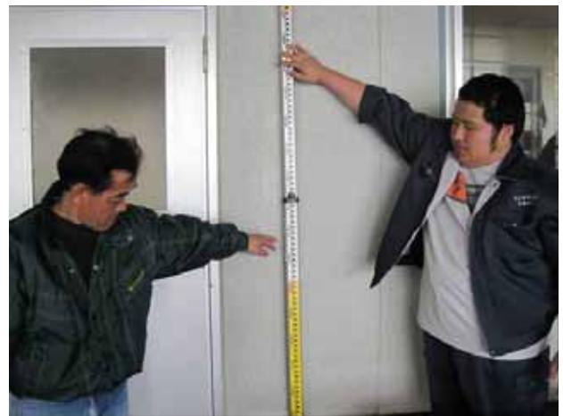
写真 3.3.4.6 関根漁港の津波遡上点。津波；2.29m（TP）。
