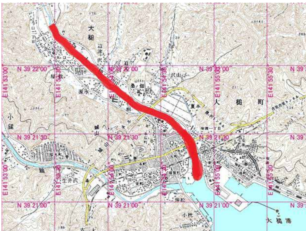
図3.4.6.1 大槌町大槌川の調査地点。赤色太線：津波遡上範囲、遡上点は現地漂流物を確認し、GPSを用いて測定。大槌川は小槌川の北に位置しており、河口は互いに向き合うように大槌湾北部奥に出ている。
