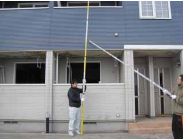
写真 3.3.2.1 八戸市市川地区津波痕跡高 地盤高 3.01 m 津波痕跡線高 3.20m 津波 6.21m。
