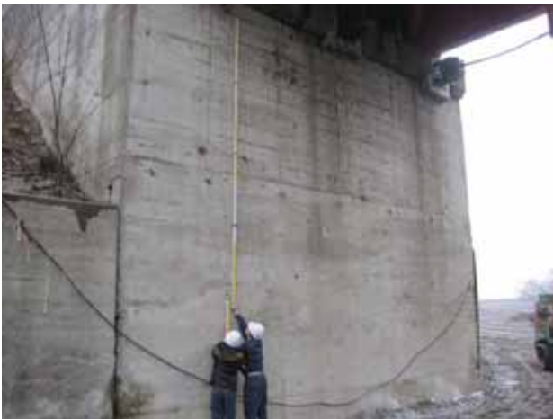
写真 3.4.4.4 水海川左岸国道橋下の津波痕跡高スタッフの頂点に痕跡線あり
