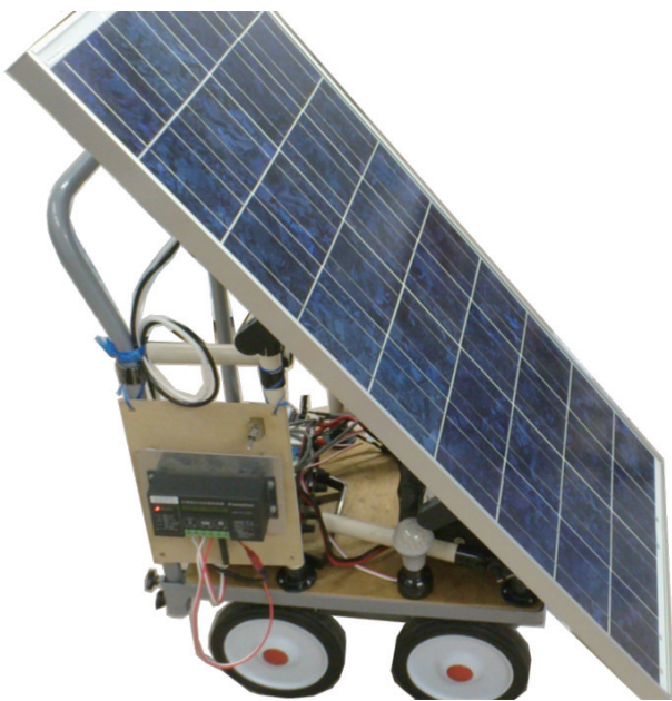
写真1 非常用可搬型太陽光給電システム
