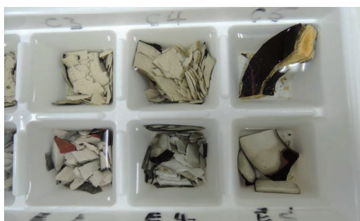
写真 4 「凍結-融解」40 回目（右端部分拡大）1100°C 焼成でもはっきりと崩壊が開始。
