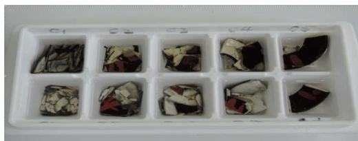
写真 3 「凍結-融解」20 回目の試験片（上段 C 試験片、下段 E 試験片：左から 800°C、900°C、950°C、1000°C、1100°C 焼成）1100°C 焼成は殆んど無傷。
