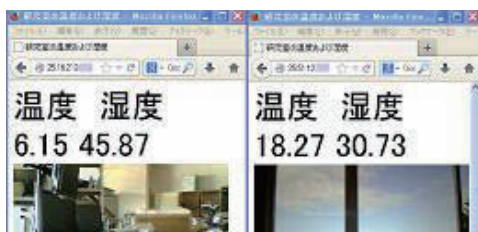
図5 Webブラウザによるカメラ画像と温湿度情報の確認
