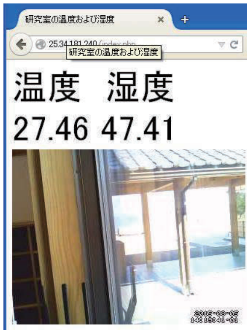
図5 Webブラウザによるカメラ画像と温湿度情報の確認
