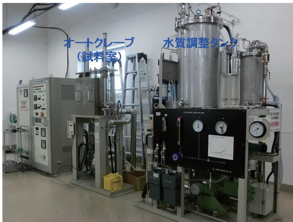
写真1 室蘭工業大学に移設した高温・高圧水環境下材料試験装置の外観
