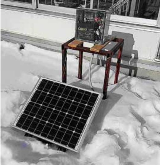
図6 太陽光パネルによる自立型遠隔監視システム
