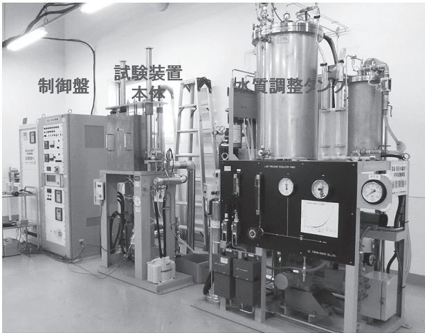
図1 室蘭工業大学に移設した高温高圧水環境下材料試験装置の外観
