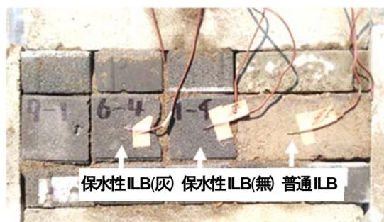
写真-1 日射による保水性 ILB 切片などの表面温度の測定状況
