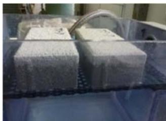
写真-6 吸水性試験状況
