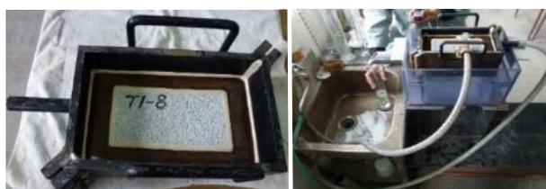
写真-7 透水性試験の装置と試験状況
