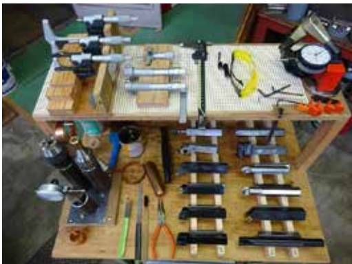
写真6 使用した工具台とバイト類
