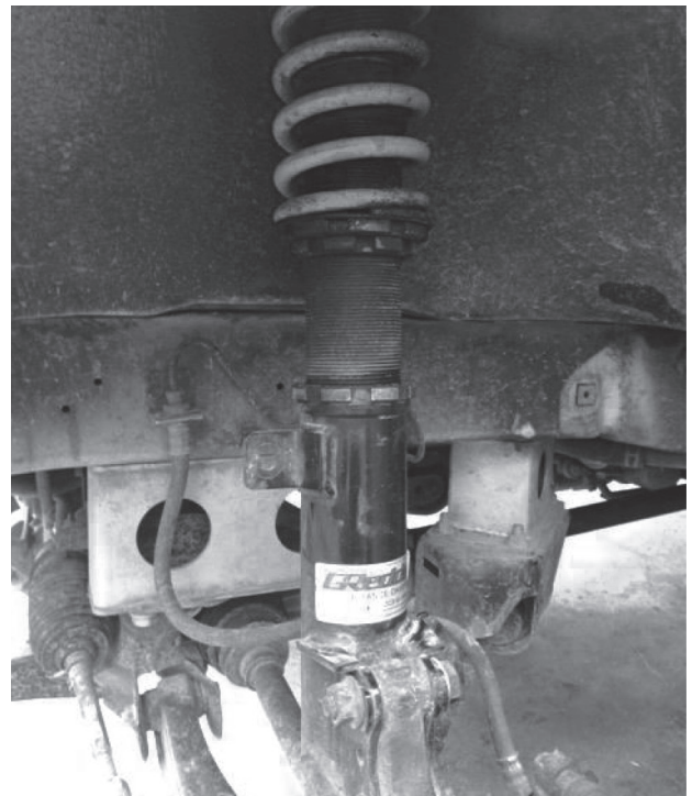
写真 4 車高調整式フロントストラット
