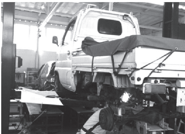
写真 2 リフトアップキット組み付け状況
