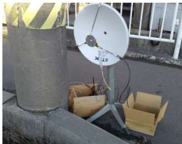
図7 パラボラディッシュ付・方向判別センサの路上評価
