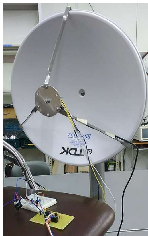
図4 電波センサへのパラボラディッシュの取り付け
