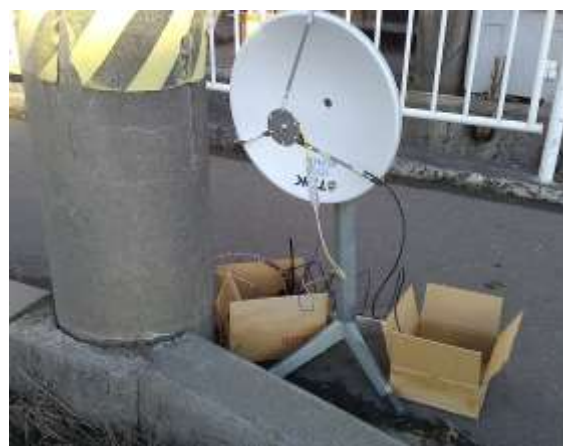
図5 パラボラディッシュを取り付けた電波センサの路上評価
