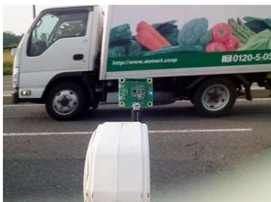
図3 新日本無線製のドップラーセンサによる路上での検証
