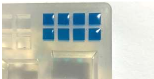
写真3 シリコンモールドに流し込んだ着色レジン液
