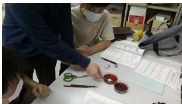
図 5 チタニア電極への色素の塗布
