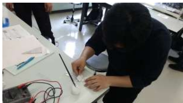
図 3 ガラス板へのチタニアペーストの塗布
