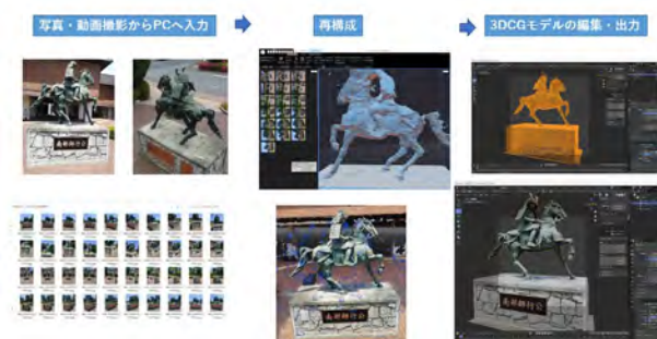
図1. フォトグラメトリーによる3Dモデル制作のプロセス
